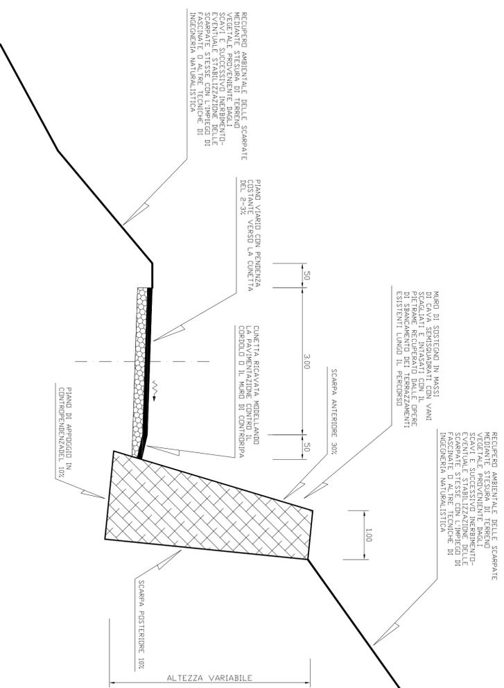
**SEZIONE TIPO SEDE STRADALE CON MURO DI SOSTEGNO - Scala 1:50**
